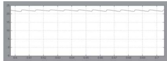
Fig. 9 Diode rectifier output voltage
